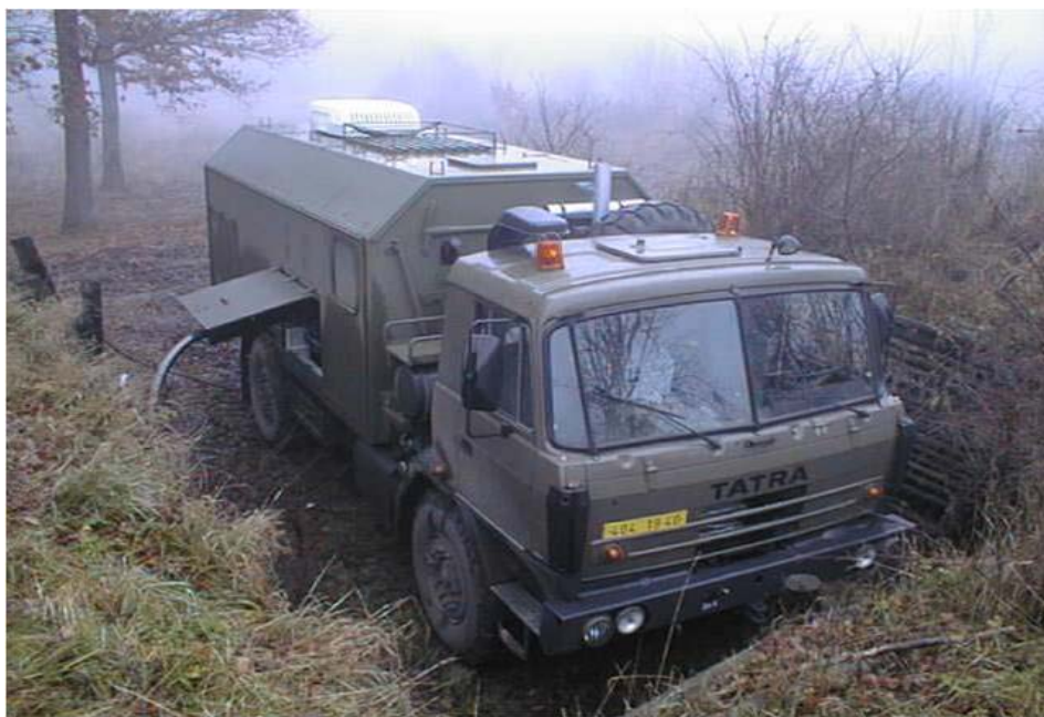
Obrázek 5.22 Rozvodna spojovacích uzlů SU 230p
