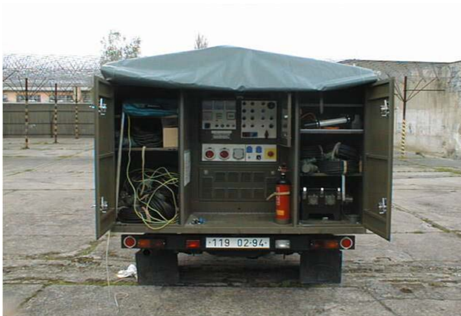
Obrázek 5.25 Vnitřní vybavení rozvodny ZRS-20 kVA LR
