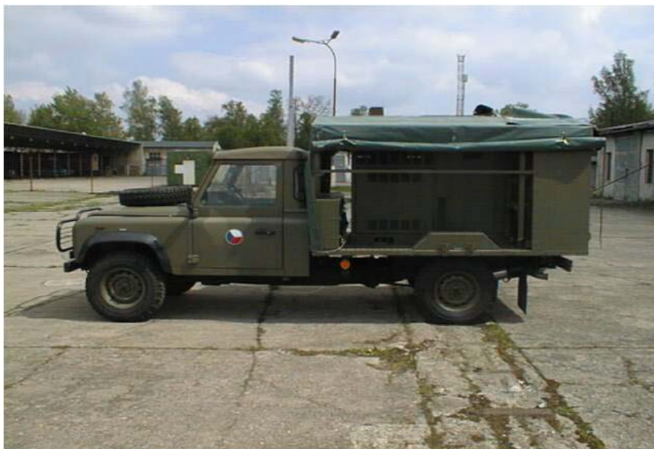
Obrázek 5.24 Rozvodna ZRS-20 kVA LR
